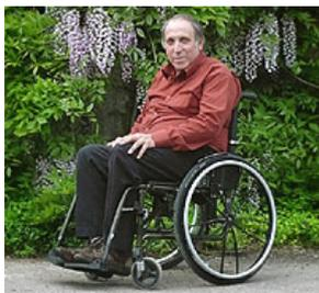
**Le fauteuil roulant manuel** moderne est un appareil simple, léger, solide et facile à transporter mais son mode de propulsion par les bras dont la force comparée à celle des jambes est modeste et pas très efficace. De plus, la façon dont s'exerce l'effort à bout de bras ne permet pas d'exploiter correctement la puissance des muscles
