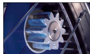
Passage du mode manuel en mode électrique en embrayant ou débrayant les pignons des moteurs.
