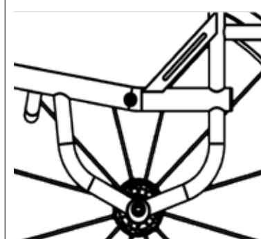
Châssis arrière en V centre de gravité fixe
