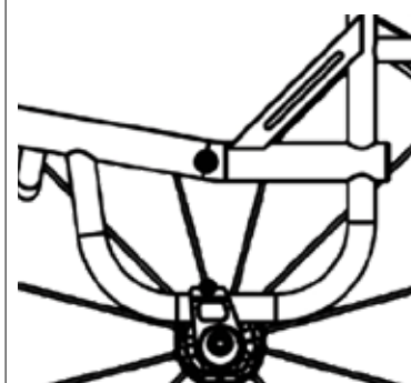
Châssis arrière rond centre de gravité réglable
