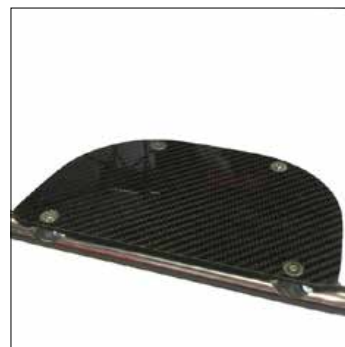
Palette tubulaire soudée au châssis avec plaque en fibre de carbone
