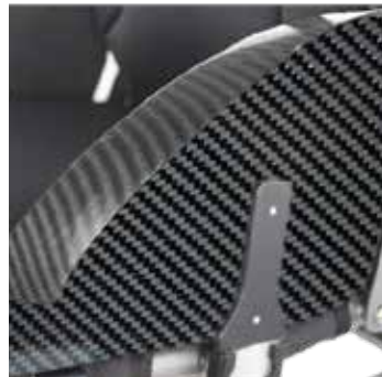
Garde boue amovible - fibre de carbone
