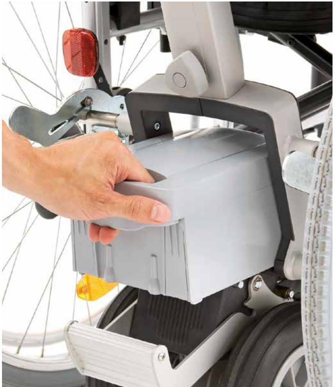
Accu-pack is eenvoudig te plaatsen en te verwijderen. Met laadansluiting. / Batterie facile à placer et à enlever. Avec connection pour chargeur.
