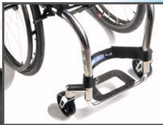
Raccordement des roues directrices par emboutissage
